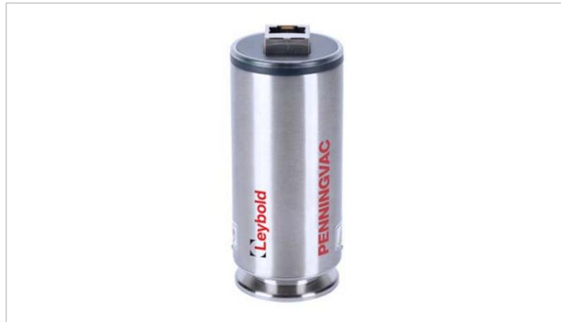
PENNINGVAC 变送器是PTR90结合了冷阴极电离原理与MEMS-皮拉尼真空规原理的全量程真空规。一台变送器就能测量从 $1 \times 10^{-8}$  mbar到大气压的压强范围。PTR90N具有设计紧凑，量程宽泛，性价比高等特点。
