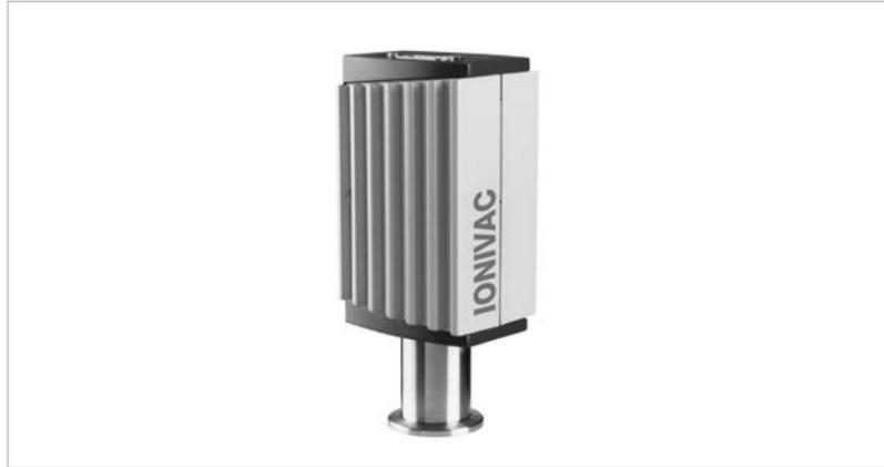
ITR 200 S变送器是基于成熟的ITR 90变送器设计，采用双阴极结构，延长了变送器的使用寿命，提高了运行可靠性。ITR200 将BA热阴极电离传感器与皮拉尼传感器相结合，可测量的真空压强范围为 $5 \times 10^{-10}$  mbar到1000mbar（适用于不可燃的气体与气体混合物）。
