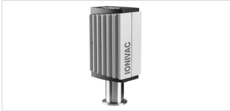
ITR 90是复合全量程真空变送器。它将BA热阴极电离传感器与皮拉尼传感器相结合，可测量的真空压强范围为 $5 \times 10^{-10}$  mbar到1000 mbar（适用于不可燃的气体与气体混合物）。
