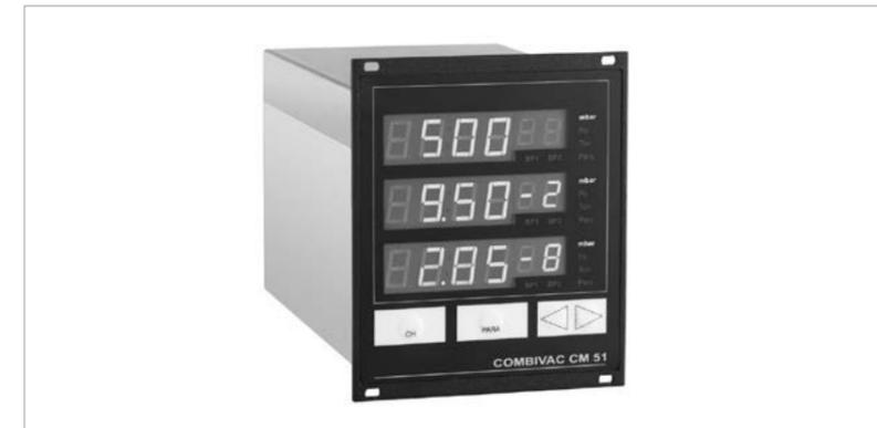
COMBIVAC CM 51结合了两种测量原理 (THERMOVAC 皮拉尼规和PENNING-VAC冷阴极规) 同时提供显示功能和测量功能, 测量范围在10<sup>-9</sup>到 1000 mbar 之间。
