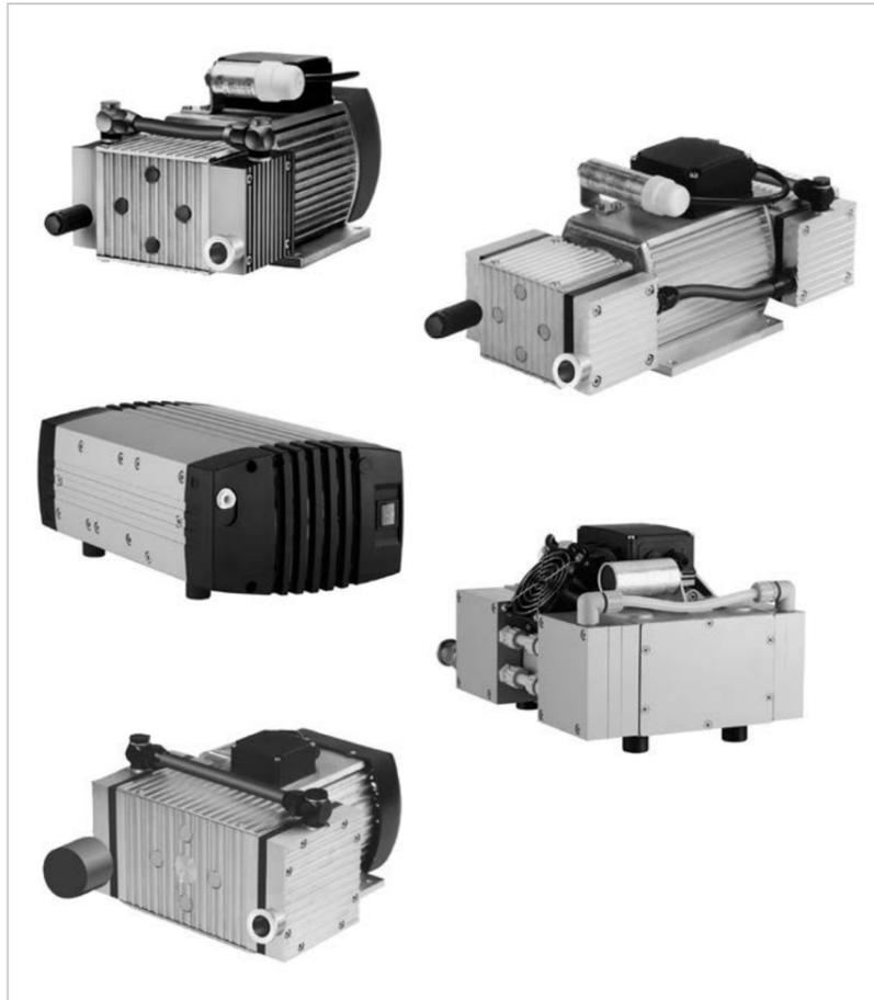
DIVAC干式压缩前级真空泵，有T系列，以及三级设计的DIVAC 1.4 HV3和3.8 HV3。所有型号都确保了无油的前级真空。采用三级设计，可在较低压强范围内提供更高抽速，因此非常适合用作涡轮分子泵的前级真空泵。所有型号泵同样也适合在普通低中真空应用中抽送洁净介质。
