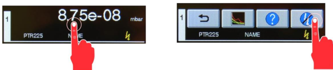
图 24-关闭高真空测量回路
