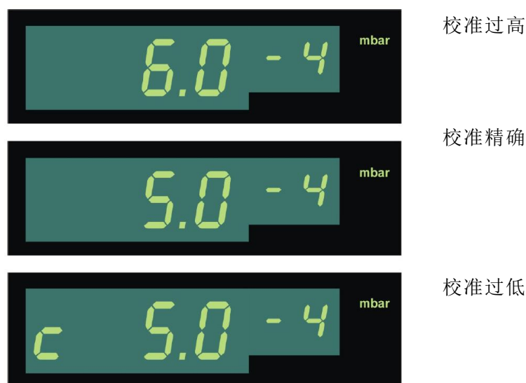
图 19 - THERMOVAC 传感器的零点调整
