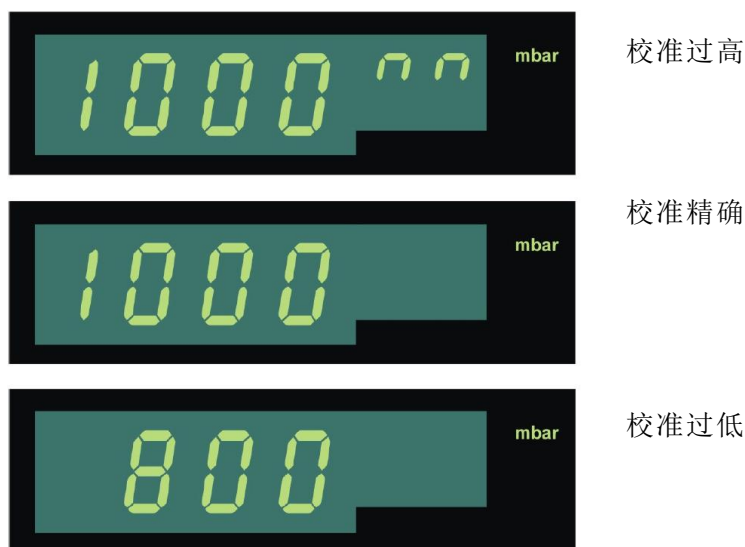
图 18- THERMOVAC 传感器的满标度调整
